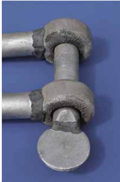
Abb. 6.5: Allgemeine Korrosion an einem nichtrostenden Schäkel (4301) nach einem längeren Aufenthalt in einem Beizbad aus Salpetersäure und Flußsäure. Die Abbildung zeigt deutlich, dass das gesamte Werkstück angegriffen ist, die Stirnflächen des Stabstahls und die Schweißnähte jedoch etwas stärker.
