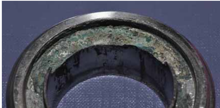
Abb. 6.19: Spaltkorrosion in einem Schweißnippel aus 4404, der einer wässrigen Kupferchloridlösung ( \text{CuCl}_2 ) ausgesetzt war. Korrosionsspuren treten insbesondere in der Dichtungsnut auf.
