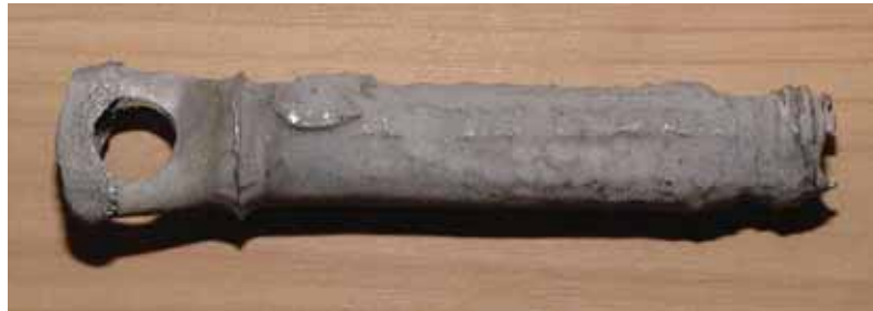
Abb. 6.2: Nichtrostende Schraube (4301) nach längerem Kontakt mit einer starken Säure zum Beizen (Salpetersäure-Flusssäure). Wie in der Abbildung deutlich zu erkennen, ist der Stoffverlust aufgrund der Korrosion relativ gleichmäßig, die Menge an korrodiertem Metall sehr hoch.
