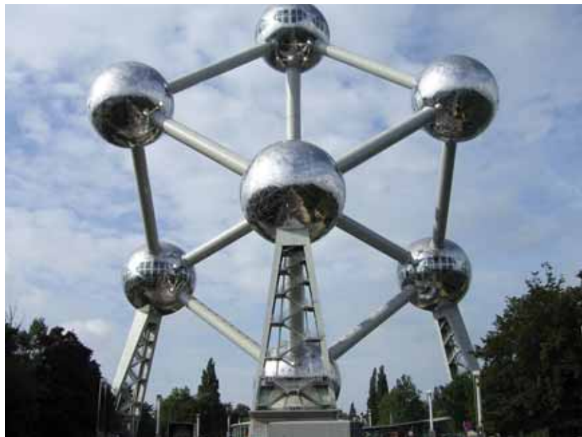
Abbildung 0.1: Das Atomium ist das Wahrzeichen Brüssels und stellt das kubisch-raumzentrierte Gitter (KRZ) des Eisenatoms dar. Das Kunstwerk ist 105 Meter hoch und wurde ursprünglich aus Aluminium für die Weltausstellung 1958 errichtet. 2005 wurde die Verkleidung durch 1,2 mm dicke Platten aus der säurebeständigen Sorte 4404 von Aperam ersetzt. Foto: Thomas Pauly, Euro-Inox [11].
