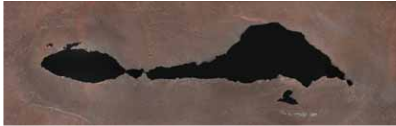
Abb. 6.6: Hochtemperatur-Salzschnmelzen haben dieselbe Wirkung auf nichtrostenden Stahl wie stark wässrige Säuren. Diese 6 mm dicke Bodenplatte eines Ofens aus 4571 (316Ti) wurde durch den Kontakt mit einem fluoridhaltigen Flussmittel zum Löten von Aluminium „durchgefressen“. Das Flussmittel enthielt bis zu 50 % Fluorid, die Temperatur betrug rund 550 °C.
