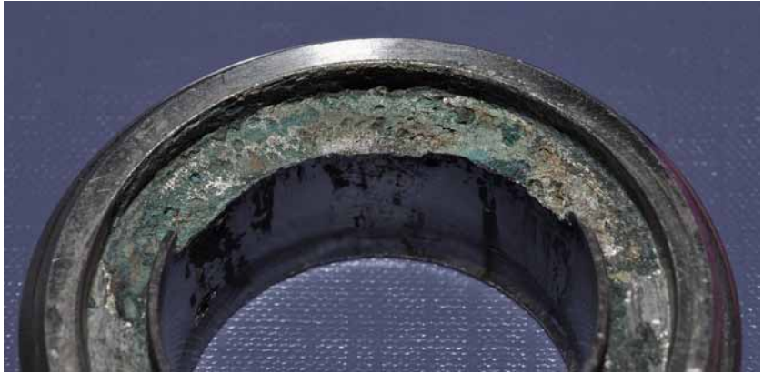
Figur 6.19: Spaltekorrosion i svejsenippel af 4404 udsat for en vandig opløsning af kobberklorid ( \text{CuCl}_2 ). Bemærk, at korrosionen er koncentreret til pakningsporet.
